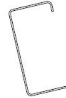
Correas en perfil COLMENA PC 120x60 x 2.0 mm
